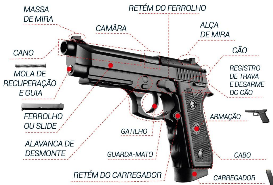
Figura 3 – Nomenclatura da pistola semi-automáticas Taurus TH9c - 9mm.
