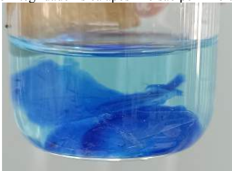
Figura 3 - Filme FO5 com perda de integridade física após imersão por 2 horas, apresentando pedaços.
