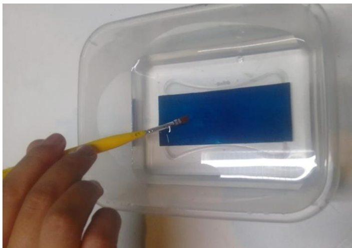
Figura 22 - Placa mergulhada na barrilha leve.
