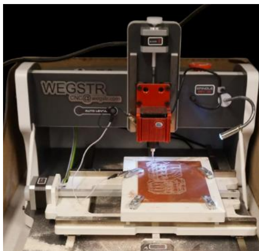
Figura 10 – Máquina de fresagem CNC em operação.
