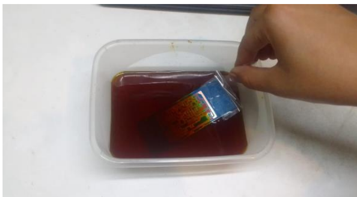
Figura 23 – Processo de corrosão da placa.
