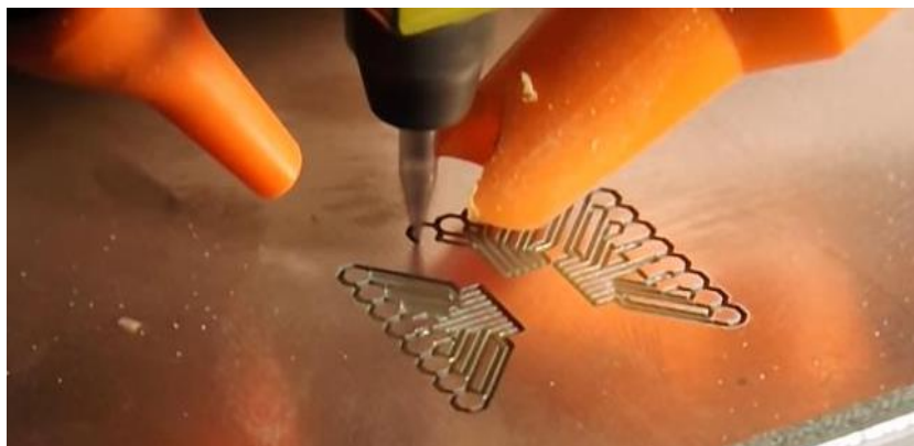
Figura 11 – Remoção de cobre na placa realizado por CNC.
