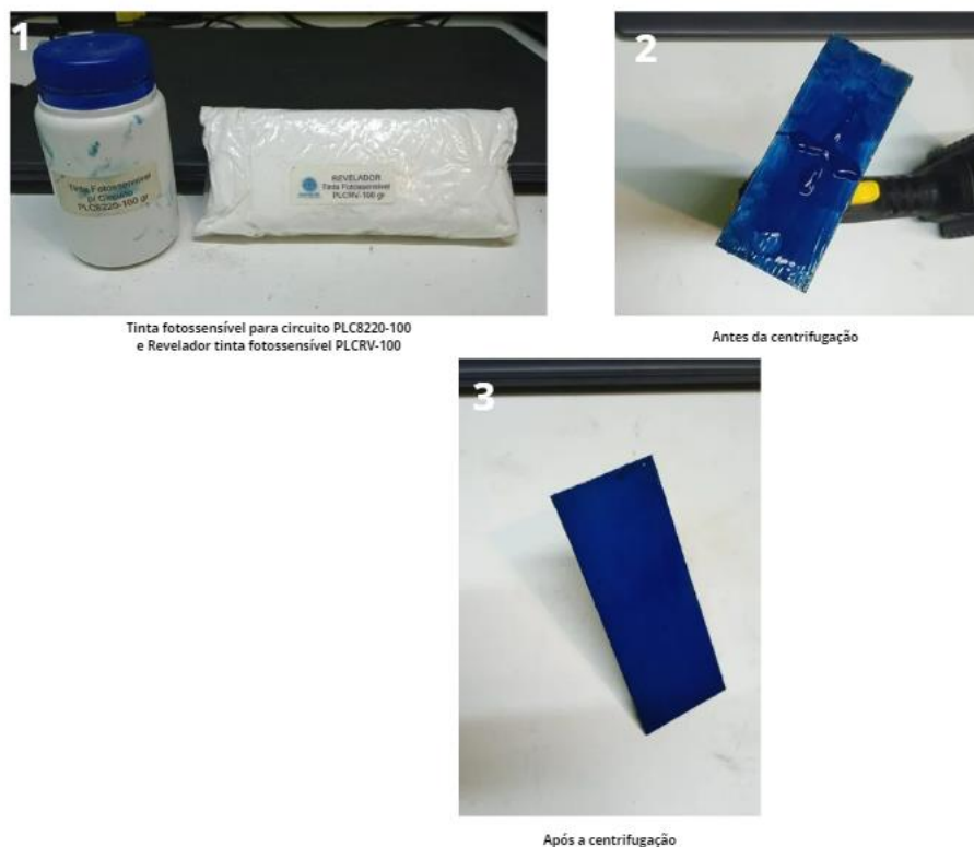
Figura 18 - Metodologia de confecção da PCI
