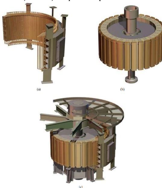
Figura 7: Estrutura do hidrogerador 4) Estator b) Rotor c) Máquina completa: estator e rotor.
