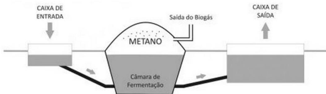
Figura 1 - Esquema básico de um biodigestor
