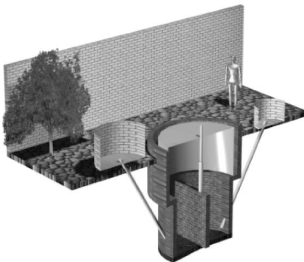
Figura 4 - Representação tridimensional em corte do biodigestor modelo indiano
