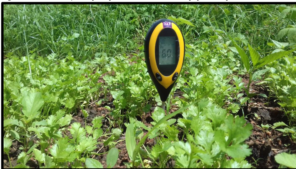
Figura 08. Determinação do pH e parâmetros do solo com equipamento portátil
