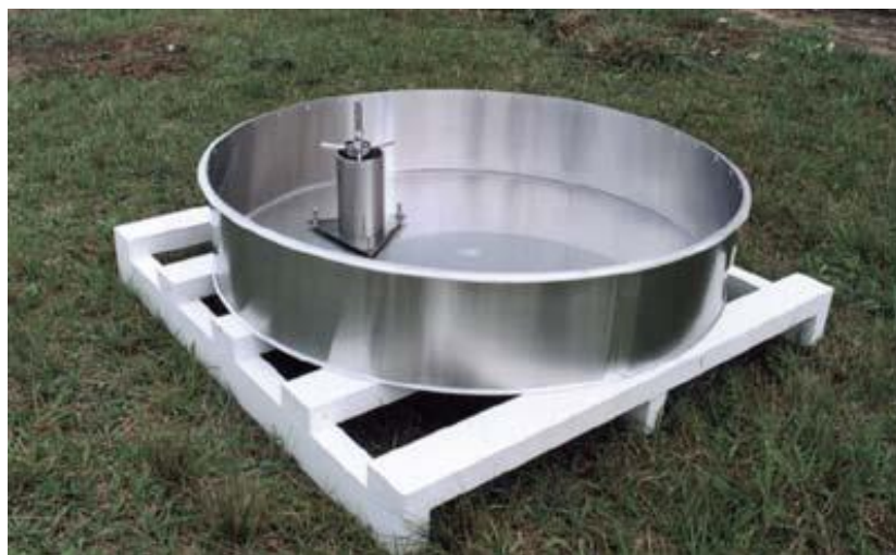
Figura 3. Tanque Classe “A”
