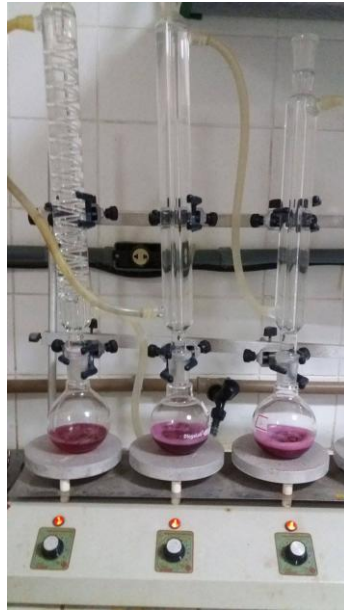
Figura 4.11 – Saponificação do óleo residual
