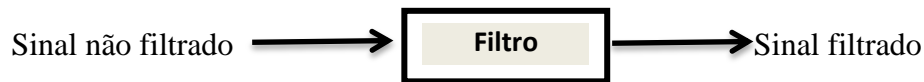
Figura 4 - Representação do processo de filtragem de um sinal Fonte: adaptado de PHYSICS (2017)
