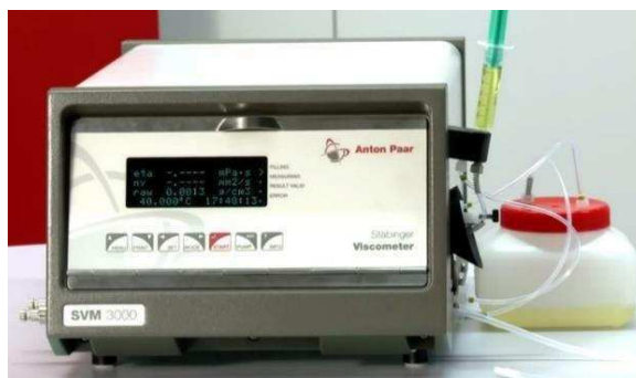
Figura 9 - Stabinger Viscometer™ SVM 3000 da marca Anton Paar utilizado na determinação da Viscosidade Cinemática (mm 2 /s) e Densidade (g/cm 3 ).
